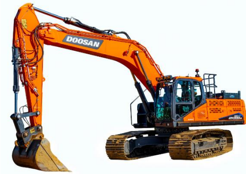
Figuur 3: Doosan elektrische graafmachine met verwisselbare accu. Bron foto: Staad-groep 1 .
