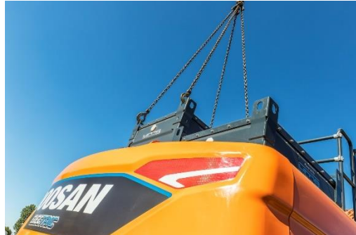
Figuur 3: Doosan elektrische graafmachine met verwisselbare accu. Bron foto: Staad-groep 1 .
